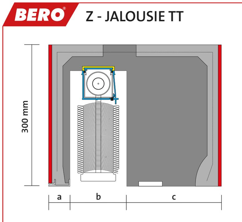
Selbsttragender Jalousiekasten aus bewehrtem BEROpor-Leichtbeton mit fest einbetonierten Ziegelblenden und zur **Aufnahme einer Außenjalousie**.
